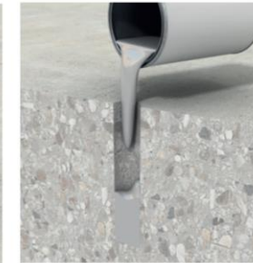
Mix & pour grout resin into hole.
