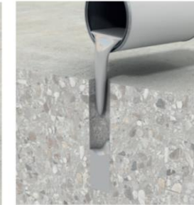
Mix & pour grout resin into hole.
